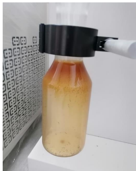
Рисунок 3.8 – Налипание МК на стенки оборудования в процессе распылительного высушивания
