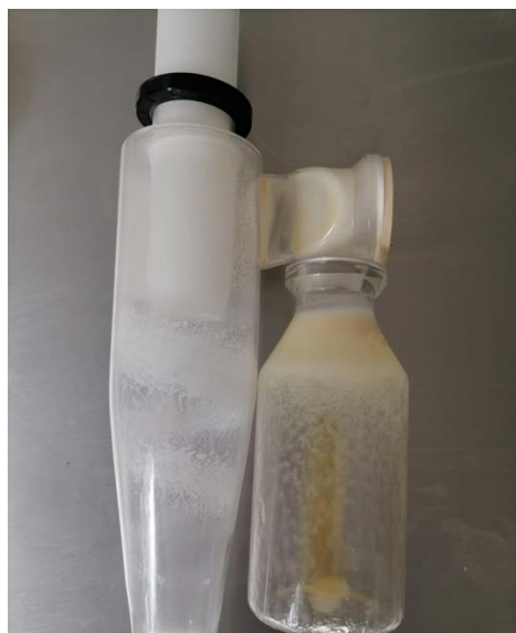
Рисунок 3.8 – Налипание МК на стенки оборудования в процессе распылительного высушивания
